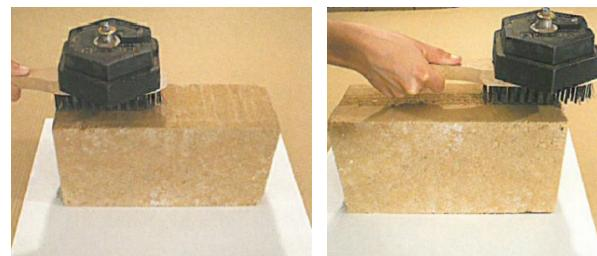
Fig. 10. Abrasion test
