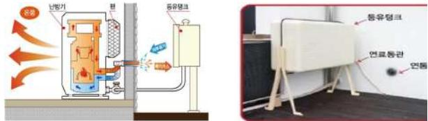
Fig. 15. Exhaust fan heater
