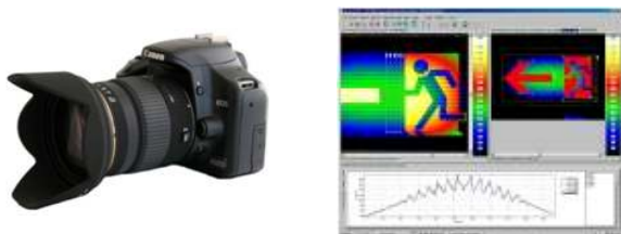
a) 카메라 및 렌즈 b) LabSoft 프로그램 그림 2. LMK Mobile Advanced 구성
